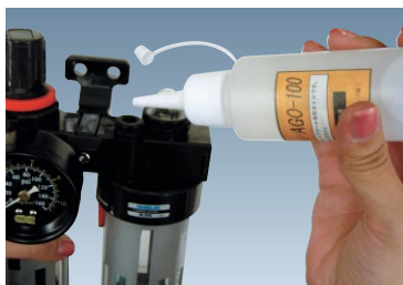
エアアプリケーターに給油
